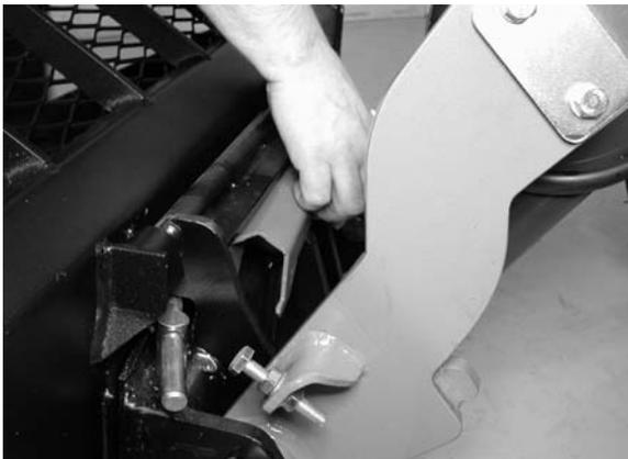
El tanque de aceite hidraulico esta situado en el eje frontal como parte del chasis delantero, asi que para acceder a la varilla y al filtro de aceite de retorno, se debera levantar el bastidor y quitar la placa tapa frontal.
