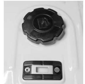
**Motor diesel:** Compruebe el nivel de combustible y rellene si es necesario. Use diesel solamente de acuerdo con las instrucciones del Manual del usuario Kubota. El uso de otros combustibles no esta permitido porque su calidad y propiedades no se pueden garantizar. Asegurese de que el tanque no se quede vacío. Si esto sucediese, reposte y arranque, el motor esta equipado con sangrado automático.
