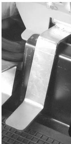
Los modelos **313S**, **314S** y **320S** tienen una función de doble velocidad (extra opcional) que se controla desde un pedal en el reposapiés (vea grabado). La doble velocidad se puede conectar o antes de arrancar o sobre la marcha. También se puede desconectar en cualquier momento levantando el pie del pedal.
