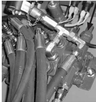
En el modelo **320S+**, la presión de la hidráulica auxiliar se ajusta desde la válvula de alivio de presión en la válvula de control de la hidráulica auxiliar (en el reposapiés, quite la placa tapa frontal para acceder a la válvula). La presión para tracción se ajusta desde la válvula de alivio de presión en la válvula principal de control.
